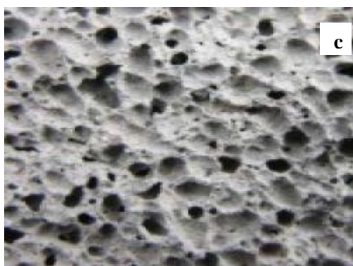
شکل (۲) تصاویر میکروسکوپ الکترونی روبشی (SEM) زغال‌زیستی کنوکارپوس (a) زغال‌زیستی باگاس نیشکر (b) و زغال-زیستی پوست سخت پسته (c) با مقیاس یکسان
