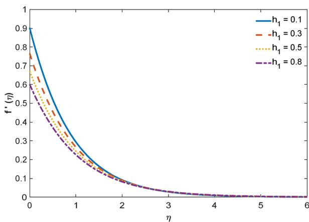
Fig. 6. Velocity field for diverse slip velocity parameter  $h_1$
