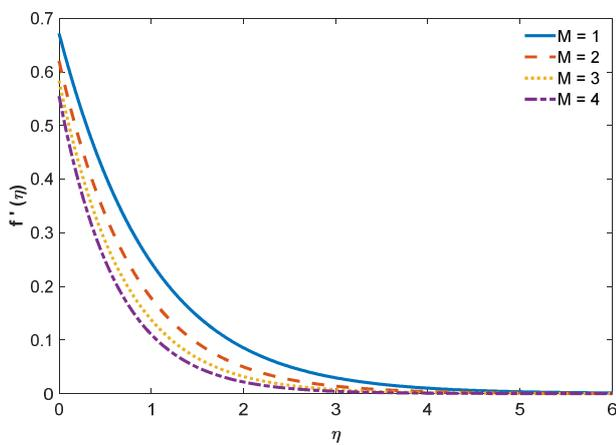
Fig. 4. Velocity field for diverse magnetic parameter  $M$
