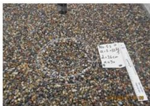
شکل ۴- چاله آبستگی با ارتفاع نصب جت ۲۴ سانتی متر و دانه بندی مصالح ۸/۷۳ میلی متر
