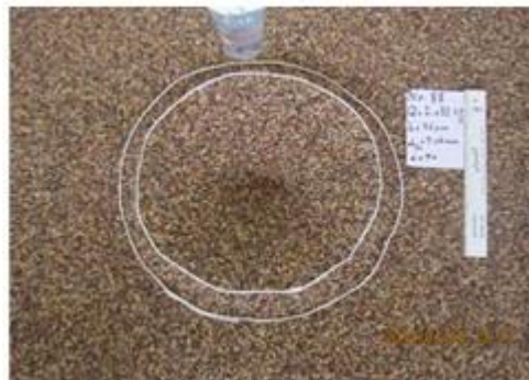
شکل ۲- شکل چاله آبستگي با ارتفاع نصب جت ۴۴ سانتی‌متر و دانه بندی مصالح ۴/۰۶ میلی‌متر
