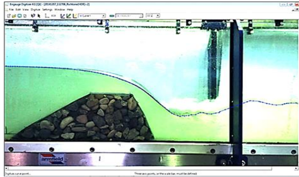
Fig. 7- Drawing of flow profile using Digitizer شکل ۷- نحوه رسم پروفیل سطح آب با استفاده از نرم افزار Digitizer
