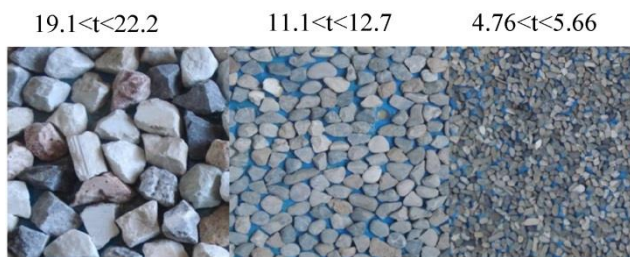
Fig. 2- Diameter range of crushed gravel sieve شکل ۲- زبری های سنگریزه های دانه بندی شده
