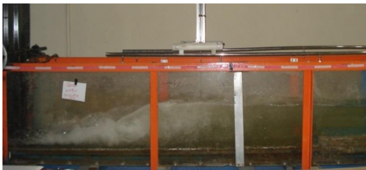
Fig. 3- Example of the free jump in roughness 4.76 < t < 5.66 , adverse slope 1.5% and positive step 6 cm شکل ۳- نمونه از پرش آزاد در زبری 4.76 < t < 5.66 ؛ شیب ۱/۵٪ و پله انتهایی ۶ سانتی متری
