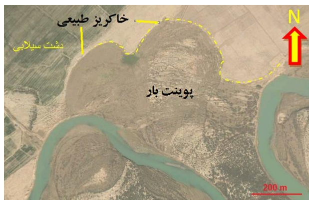
شکل ۵. خاکریز طبیعی و پوینت بار کانال رود زهره (برگرفته از Google earth)
