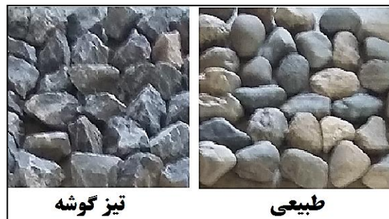
شکل ۲- تصویری از شکل سنگریزه‌ها (میلی‌متر) (d_{50}=65.3)
