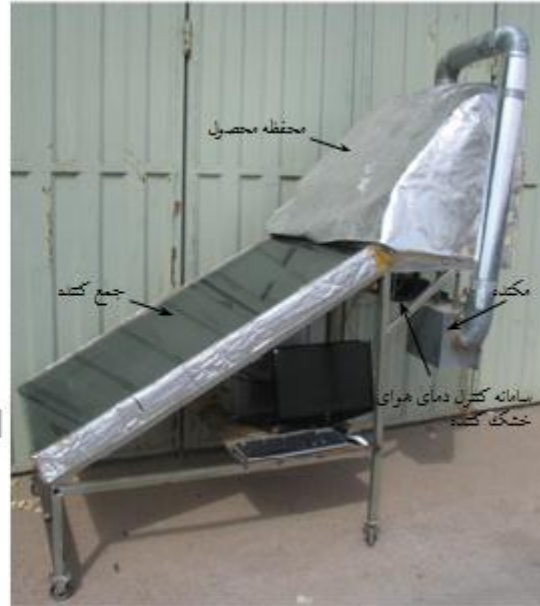
شکل (۱) تصویر و طرحواره خشک کن شامل: حسگرهای دما (۱ تا ۴)، منبع مادون قرمز (۶)، لوله ورودی مکنده (۷)، لودسل (۸)، صفحه جاذب آلومینیومی (۹)، ذخیره کننده گرمایی (۱۰)، گرم کن کمکی (۱۱)
