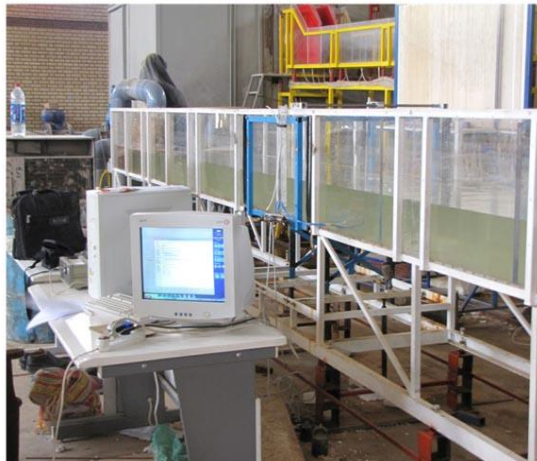
شکل ۱- نمایی از فلوم لبه چاقویی و اجزای تشکیل دهنده سیستم اندازه‌گیری
